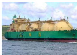
LNG wird auf Spezialschiffe gepumpt, die zu einem anderen LNG-Terminal fahren und das LNG dort wieder mit den schiffseigenen Ladungspumpen an Land fördert (Bildquelle: Wikipedia)
